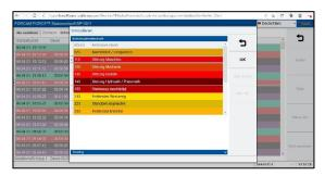
Kontextinformationen erweitern die reine Verbrauchsmessung um Informationen zu Maschinenstatus und Aufträgen bzw. Arbeitsplatzphasen und bilden somit die Basis für das spätere Reporting. Die Kontextinformationen werden vom Werker direkt im Shopfloor Terminal (SFT) hinzugefügt. Sie umfassen die Qualifikation des Arbeitsplatzstatus, das Setzen der Phasen in Rüsten oder Produktion, das Rückmelden von
