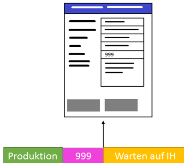
Bild 3: Änderung des Betriebszustands nach Anfordern einer Instandhaltung
